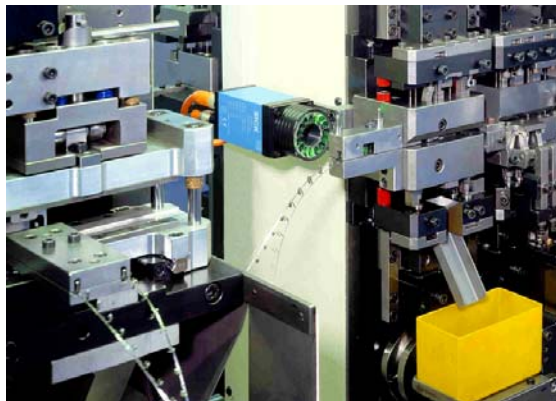
Bild 4: Anwendung des Intelligent Camera Sensors zur 100% Qualitätsprüfung bei der Produktion von Kontaktfedern
